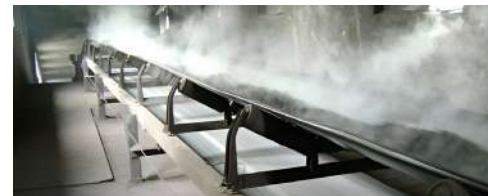
Băng tải lõi thép chịu nhiệt
