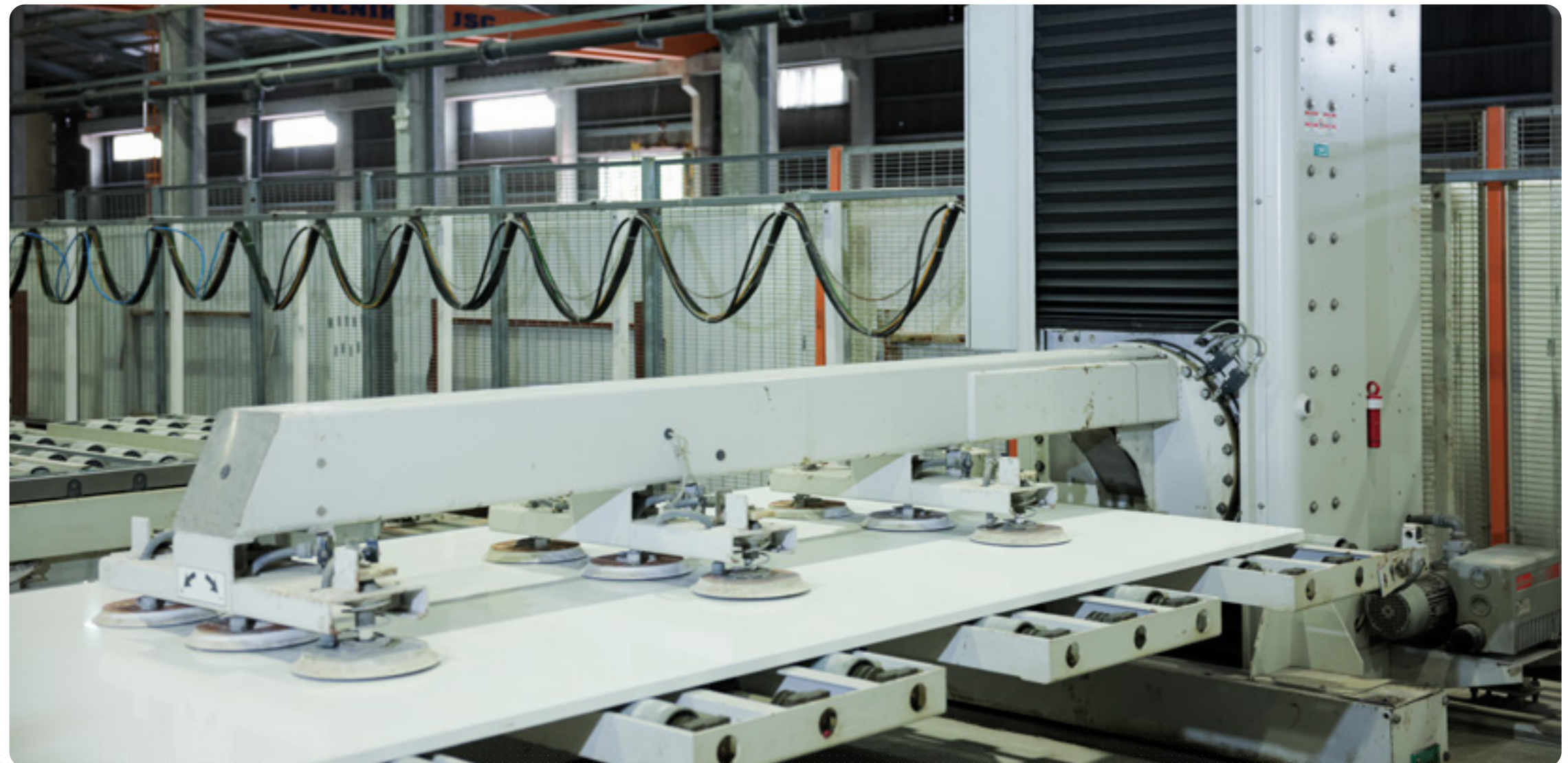
Công đoạn ra đá trên dây chuyền sản xuất đá nhân tạo Vicostone
