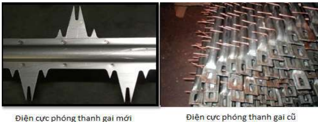
Hình 4.1.6: Điện cực phóng thanh gai thay mới và cũ
